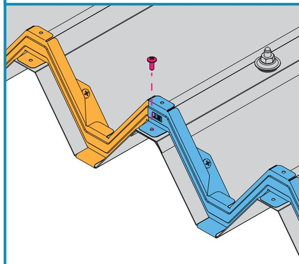
③で連結させた面戸同士を薄板用タッピングねじ（現場調達）で固定し施工完了です。
