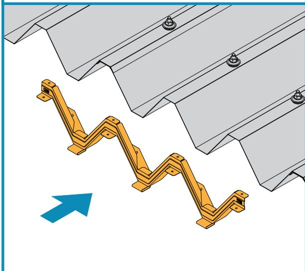
下折版の軒先の谷部に 88 ツイン面戸の爪部を引っ掛け差し込みます。
