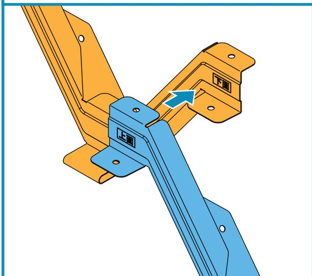
②で固定した面戸の「下面」刻印の上に次の面戸の「上面」刻印が重なるように連結させます。
