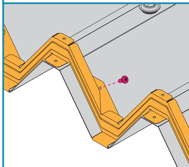
薄板用タッピングねじ（現場調達）で 88 ツイン面戸を下折版の斜面に固定します。（面戸 1 枚につき 6 箇所）
