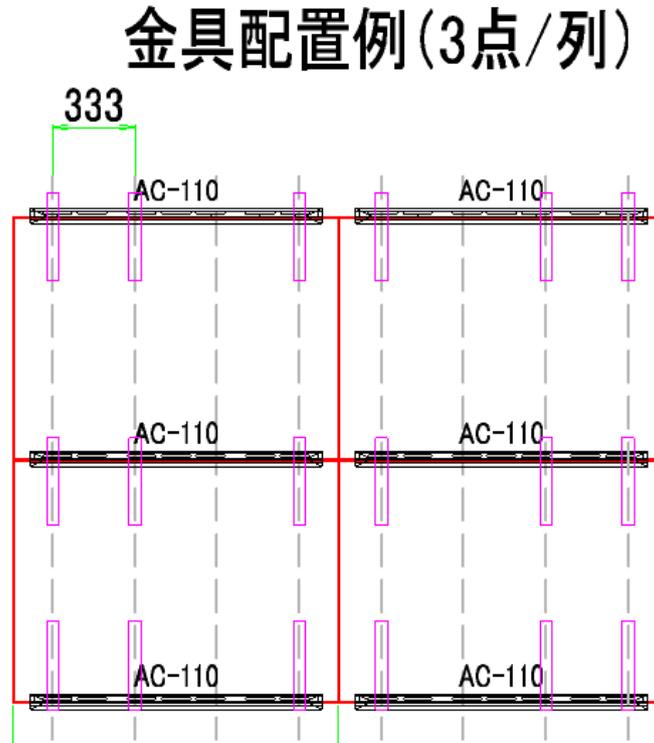
図 1.Y 横棧取付金具配置参考図
