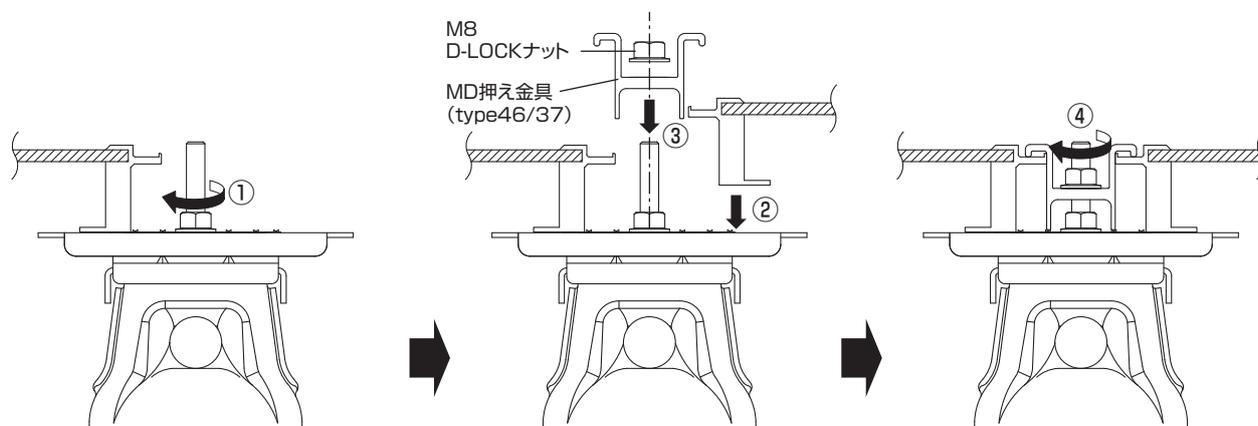
① 共通受け金具(F)の上に太陽電池モジュールを仮置きし、共通受け金具(F)を固定しているM8 D-LOCKナットを本締めします。
