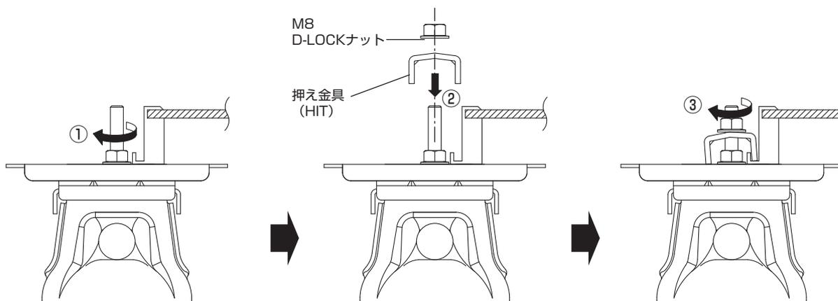
① 共通受け金具 (F) の上に太陽電池モジュールを仮置きし、共通受け金具 (F) を固定している M8D-LOCK ナットを本締めします。
