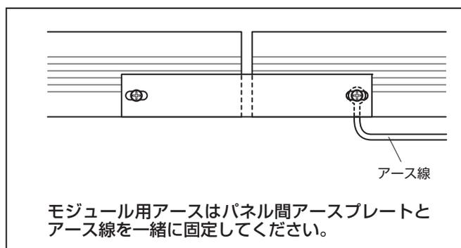
パネル間アースプレートは、棟側及び列方向の導通が可能な位置に取付を行ってください。パネル間アースプレートと太陽電池モジュールの棟側側面の下端を合わせて、しっかりと押えた状態で長穴2カ所に付属のテクスビス2本を太陽電池モジュールにもみつけて取付、固定します。
