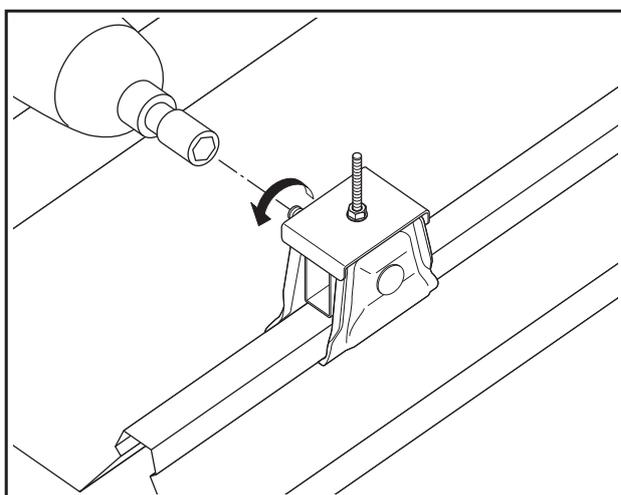
③ インパクトレンチなどで本体側面のナットを仮締めします。金具の傾きやズレがないことを確認し、ナットを本締めします。
