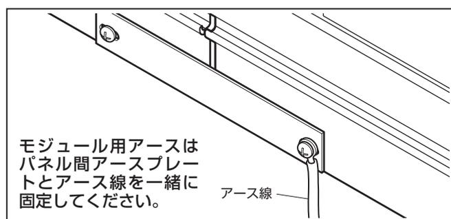
パネル間アースプレートは、棟側及び列方向の導通が可能な位置に取付を行ってください。パネル間アースプレートと太陽電池モジュールの棟側側面の下端を合わせて、しっかりと押えた状態で長穴2カ所に付属のテクスビス2本を太陽電池モジュールにもみつけて取付、固定します。
