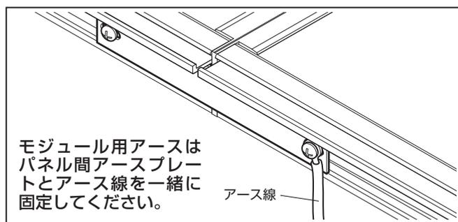
パネル間アースプレートは、棟側及び列方向の導通が可能な位置に取付を行ってください。パネル間アースプレートと太陽電池モジュールの棟側側面の下端を合わせて、しっかりと押えた状態で長穴2カ所に付属のテクスビス2本を太陽電池モジュールにもみつけて取付、固定します。この時、テクスビスが太陽電池モジュールの枠に組み付けてあるビスに干渉しない位置に取付を行ってください。
