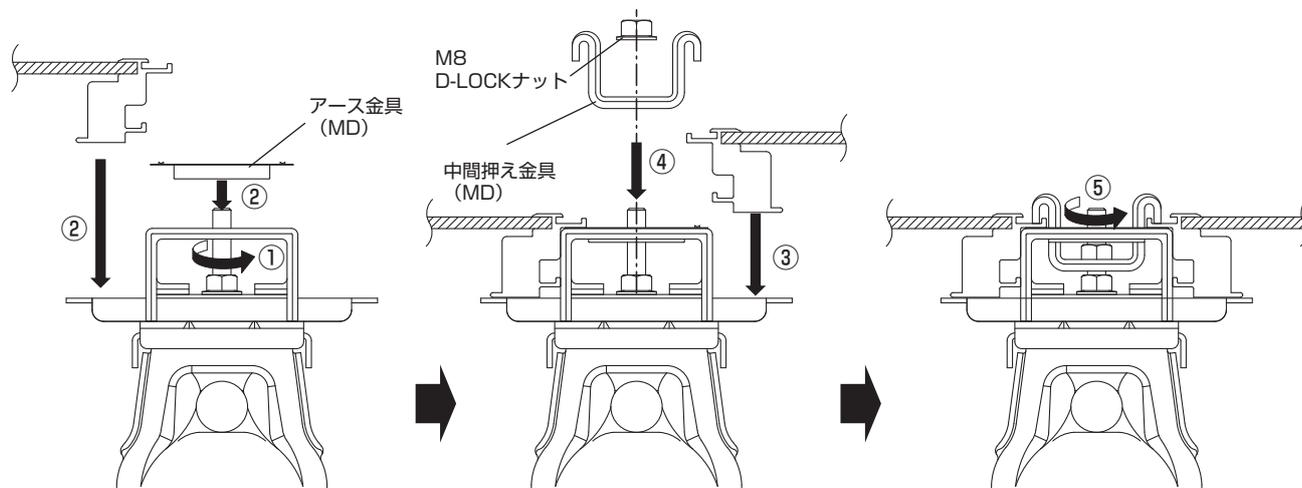
① 共通受け金具 (F) ・レベルプレート (FH36) を固定している M8D-LOCKナットを本締めします。
