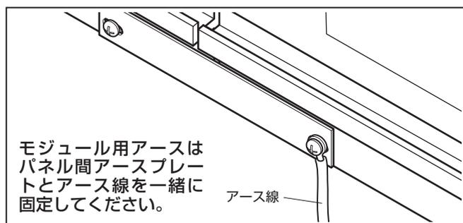
パネル間アースプレートは、棟側及び列方向の導通が可能な位置に取付を行ってください。パネル間アースプレートと太陽電池モジュールの棟側側面の下端を合わせて、しっかりと押えた状態で長穴2カ所に付属のテクスビス2本を太陽電池モジュールにもみつけて取付、固定します。
