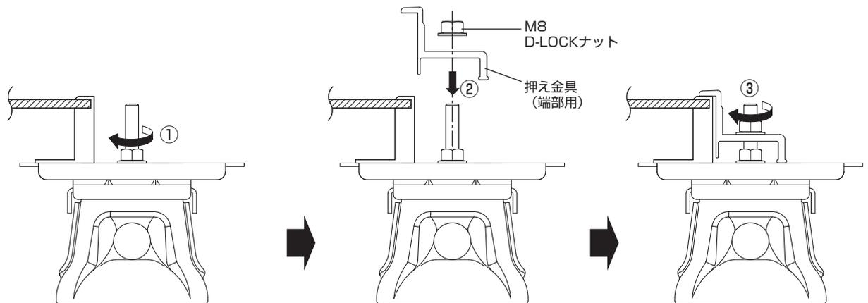
① 共通受け金具 (F) の上に太陽電池モジュールを仮置きし、共通受け金具 (F) を固定している M8D-LOCK ナットを本締めします。
