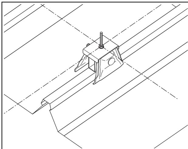
② 墨出し交点の位置に金具の上ボルトの中心が合うように仮置きをしてください。
