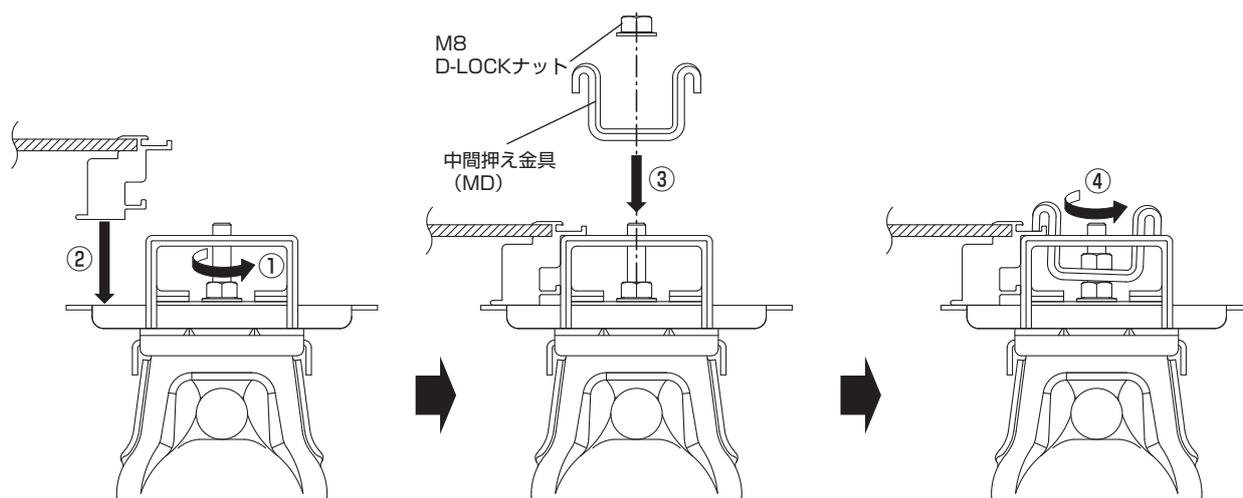
① 共通受け金具 (F) ・レベルプレート (FH36) を固定している M8D-LOCKナットを本締めします。
