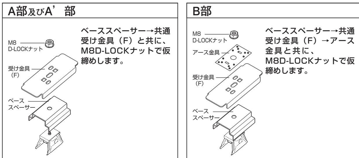
(2) A部(軒先1段目)の取付手順 … 軒先1段目のモジュールは以下の手順で取付します。
